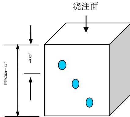
1、回弹值测量应选用不同于声时测量的另一相对侧面。将试块油污擦净放置在压力机上下承压板之间，加压至30~50kN，并在此压力下，在试块相对测试面上按本规程第4.2.2条规定各测8点回弹值，剔除3个最大和最小值，将余下10个回弹值的平均值作为该试块的回弹值 $R_a$ ，计算精确至0.1；
